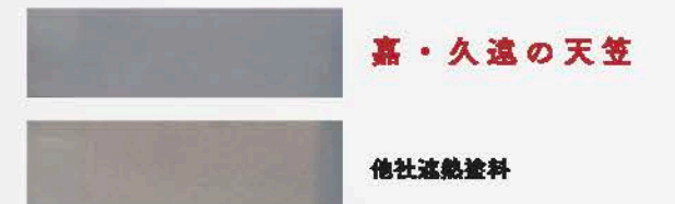
宮古島暴露試験における経年劣化試験（黄変変化比較試験）
